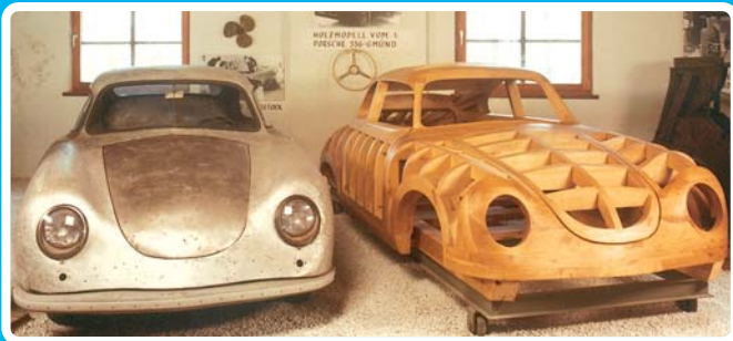
Гмюндовское Porsche 356 – алюминиевый кузов, с деревянной моделью
