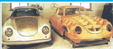
Porsche di Gmünd 356 - alluminio, con modello di legno
